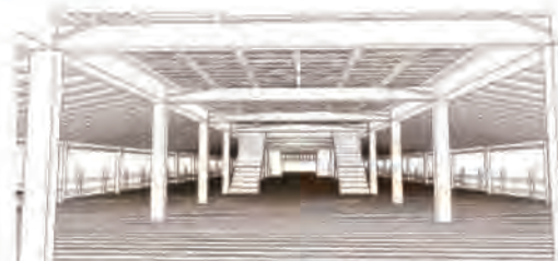
【町家建築の特徴的な構造形式を用いる】 連立フレームを構造体に加え、ここで動線空間として機能する。
